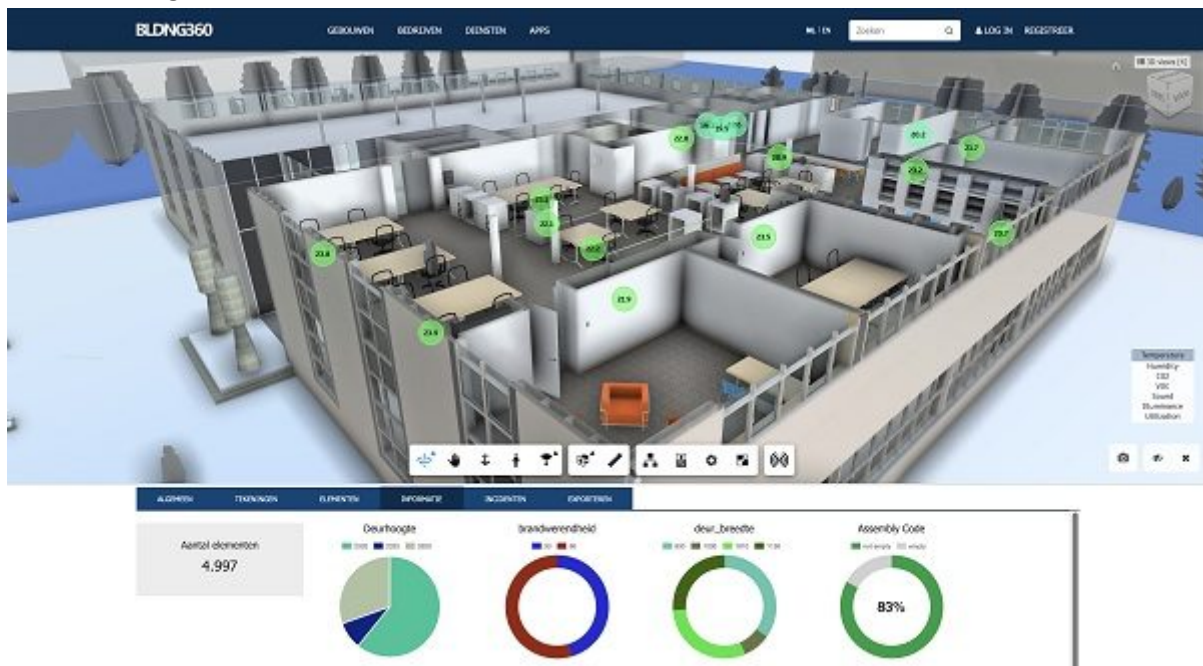
Figuur 22: Sensordata die terugkomt in een digital twin in het 3D model en een dashboard (Cobouw, 2019)
