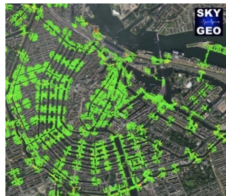
Figuur 44: Digitale tool van Skygeo waarin funderingsherstel kan worden gemonitord met satellietbeelden (Skygeo, 2021)
